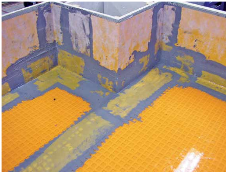
Die Unternehmen Rigips und Schlüter-Systems haben ihr Trockenbau-Abdichtungssystem bei der Säurefliesner-Vereinigung testen lassen. Der Versuchsaufbau bestand aus einer Konstruktion in den Maßen 125 x 125 x 30 Zentimeter mit einer 35 x 35 Zentimeter einspringenden Ecke.
