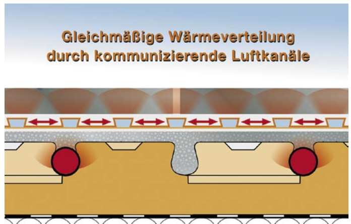
Mit dem neuen Keramik-Klimaboden gibt es jetzt zur Belagskonstruktion auch die passende Heiztechnik. Das Komplettssystem verspricht rissfreie Belagskonstruktionen mit besonders effektiver Wärmenutzung.
