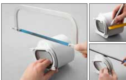
5 ... zu einer Mindesteinstecktiefe von 15 mm kürzen (max. Einstecktiefe 90 mm). Anschließend Schnittkante anphasen.
