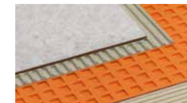
Schlüter®-DITRA 25 Abdichtungs- und Entkopplungsmatte für Fliesenverlegung auch auf kritischen Untergründen (z. B. Holz-, Gips- oder rissebehaftete Untergründe)
