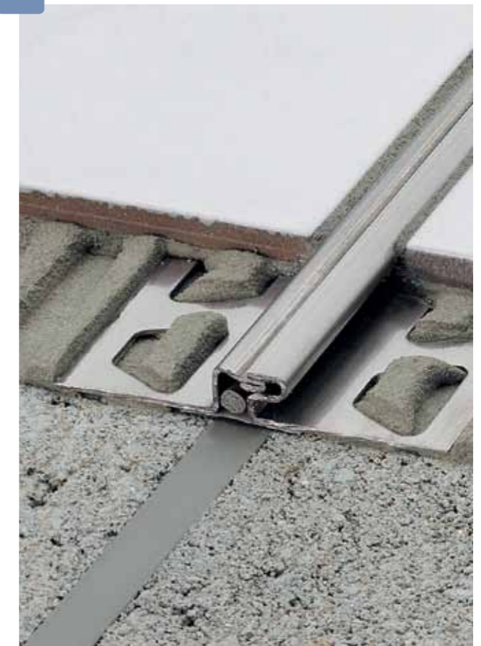
Von unten nach oben: Die Fuge im Estrich wird übernommen. Trapezförmig gelochte Befestigungsschenkel sorgen für eine sichere Verkrallung im Verlegemörtel. In der fertigen Fläche steht das Profil maximal 1 mm unter dem Belag.
