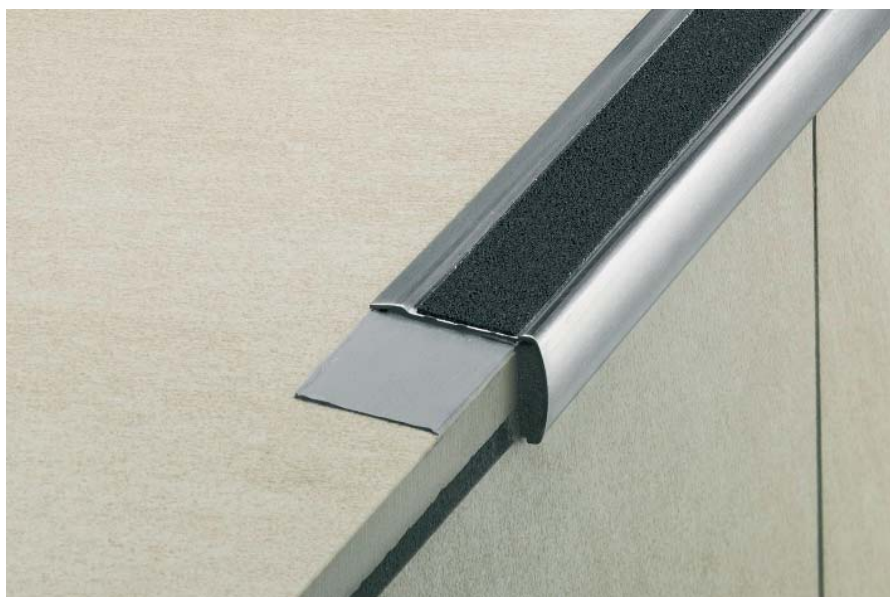
Schlüter-Trep-GK ist eine Variante ohne Befestigungsschenkel mit der höchstmöglichen Rutschhemmung R13. Das Profil eignet sich zum Aufkleben an Stufenkanten, z.B. zum nachträglichen Einbau an beschädigten Kanten, so dass diese nicht erneuert werden müssen.
