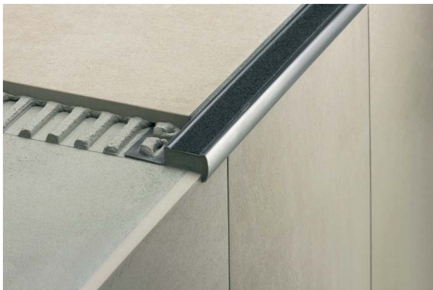
Schlüter-Trep-G aus Edelstahl ist mit einem speziellen rutschhemmenden Auftritt versehen. Das eingebettete Klebeband besteht aus einer farbigen Mineralkörnung und verleiht dem Profil die Rutschhemmung R 13. Das Treppenprofil lässt sich in Beläge aus Fliesen oder Natursteinplatten sowie in Estriche oder in Beschichtungsmaterialien einarbeiten.
